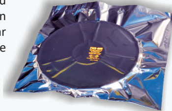
Sac barrière scellé avec une légère dépression
