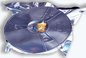
Sac barrière scellé avec une dépression trop fort
