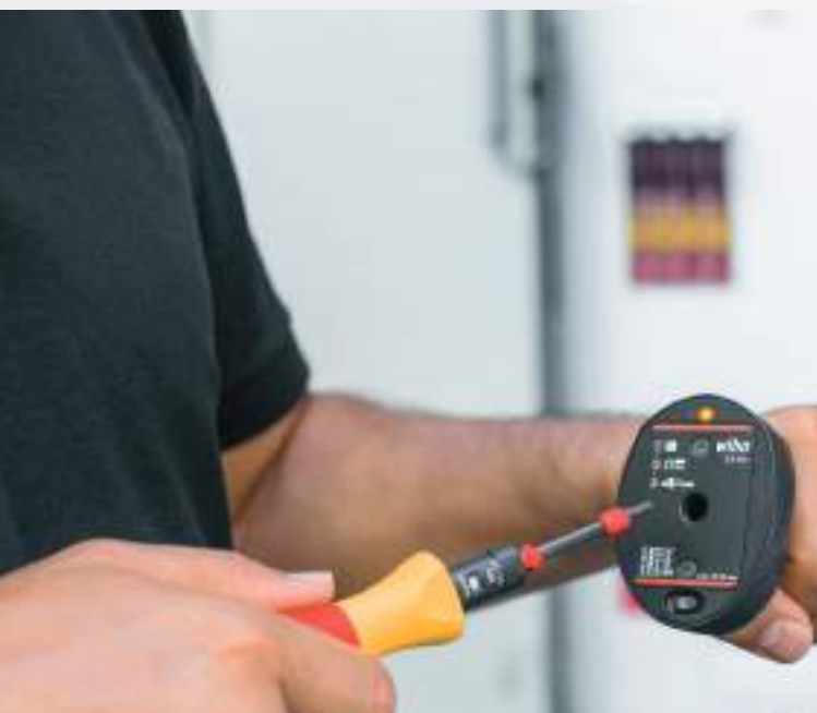
Contrôle mobile des outils dynamométriques
