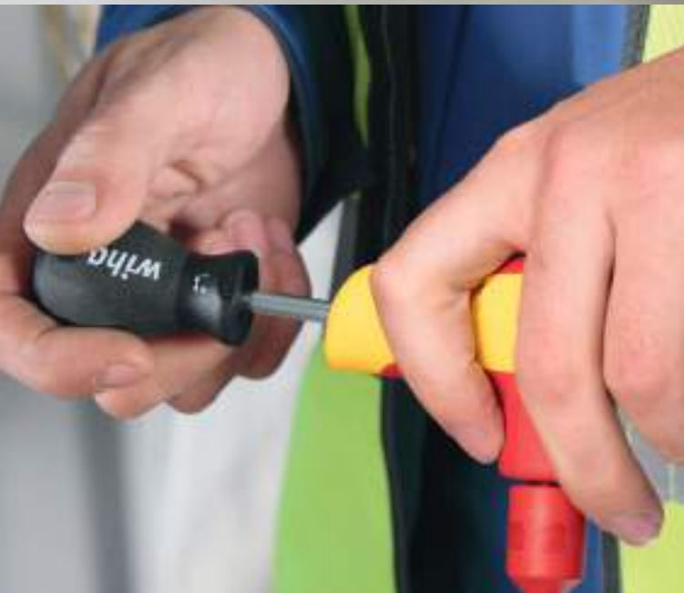
Couple de serrage à réglage variable
