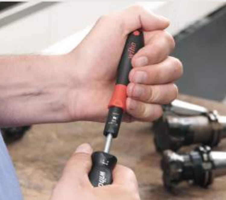
Couple de serrage à réglage variable
