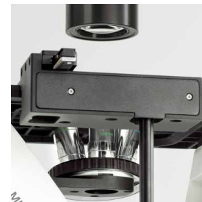
Les boutons coaxiaux de réglage des x/y peuvent être installés à droite ou à gauche
