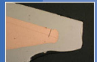
Seitenansicht nach 20.000 Abschmelzvorgängen bei 380°C side-view after 20,000 melting procedures at 380°C
