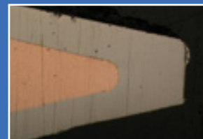
Seitenansicht nach 20.000 Abschmelzvorgängen bei 380°C side-view after 20,000 melting procedures at 380°C
